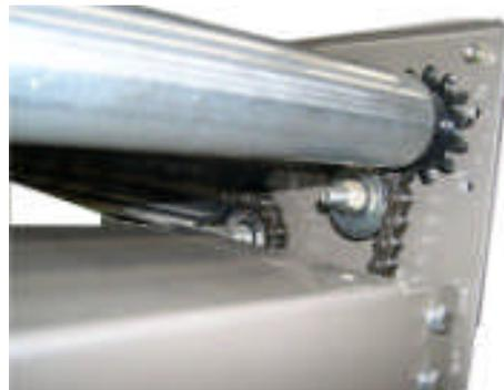
Staffe standard di fissaggio trasportatore TRRM alle gambe, tali staffe sono predisposte per poter eventualmente inclinare il trasportatore in caso di necessità.
